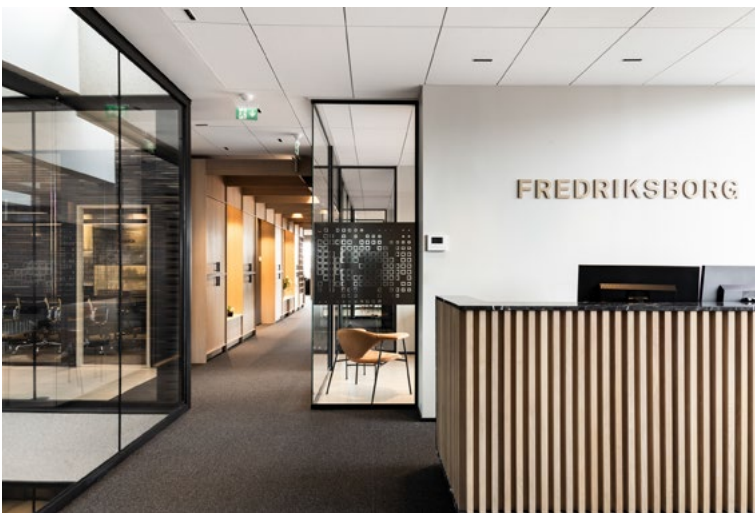
Betonggulv og hvitt eik i ulike kvaliteter som parkett, perforerte lydabsorbenter på vegg, dører og heltre håndløper, møter stål og tegl.
