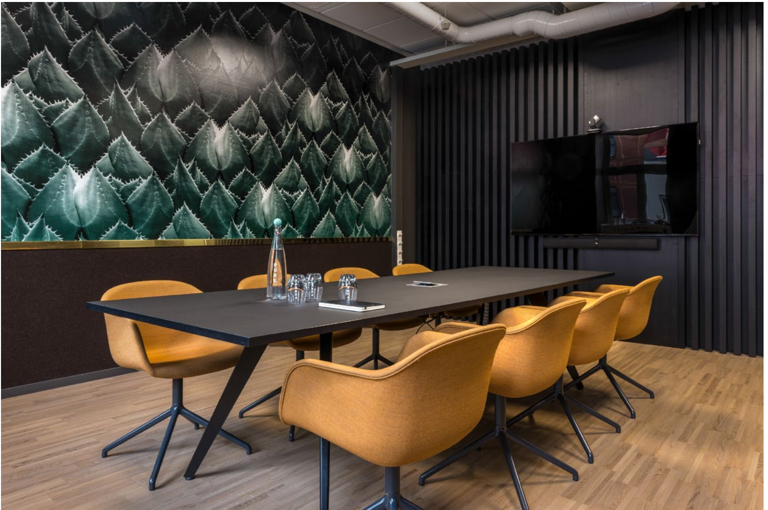
Møterommet skal inspirere brukerne og har fått navnet Growth. Et kreativt design virker stimulerende og innbyr til aktiv deltakelse. Akustikken er ivarettatt gjennom samme type spillevegg som i resepsjonen, og det er dessuten brukt brystning av ullfilt.
