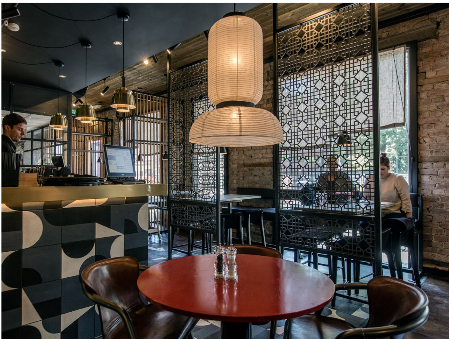
Skjermene og halvtransparente romdelere er gjennomgående innredningselementer. Skjermene skåret i varmvalset stål er avledet av den grafiske profilen til restauranten.
