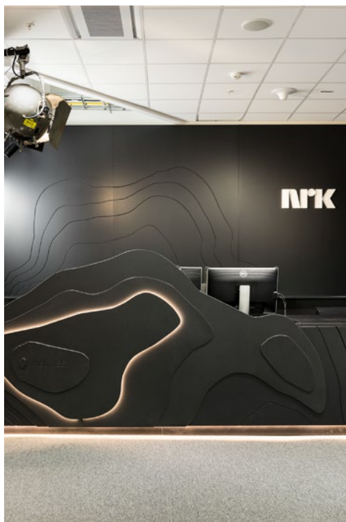
Den lokale forankringen vises her i resepsjonen, som er en utfresning av kotehøyder fra kartet over Hardangerjøkulen. Utført i sort valchromat. All spesialinnredning er produsert av NRKs eget snekkerverksted på Marienlyst.
