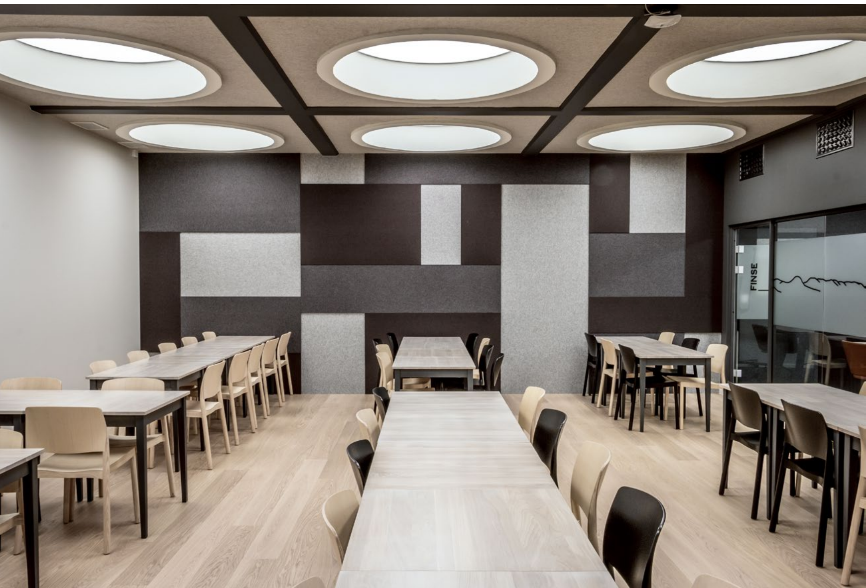
Deler av kantineområdet, med møterom i bakkant. Fondvegg med lydabsorberende filt. Eksisterende runde betong-vinduer er hentet frem og kledd med filt for enda bedre lydabsorbasjon.
