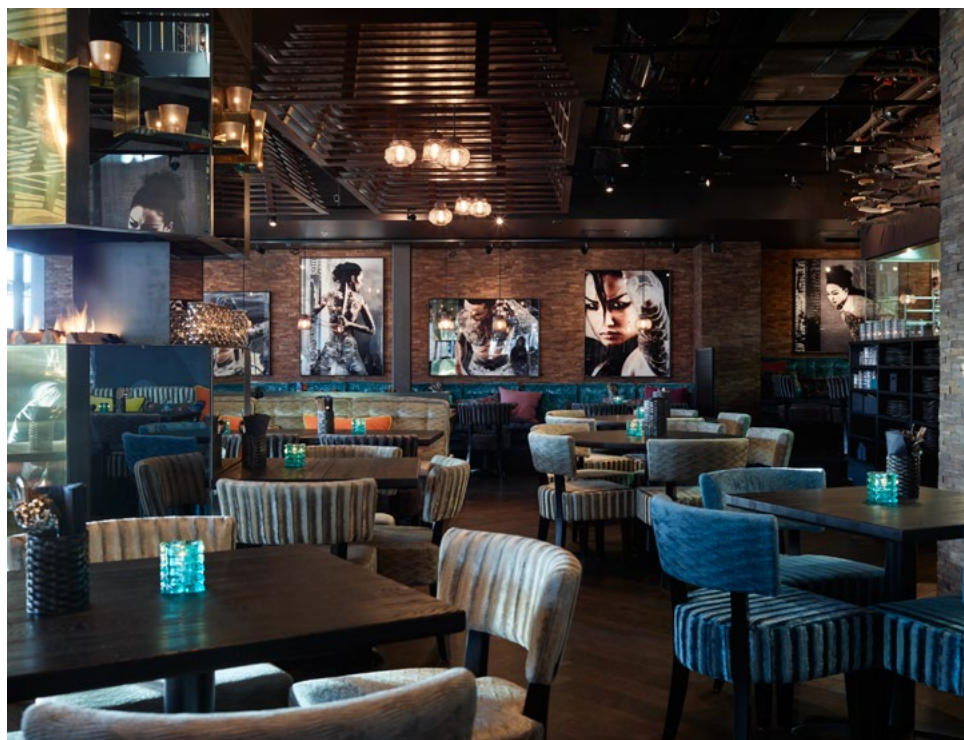
Trespilevegg i en varm tone er valgt for å gi en kontrast til det mørke og sorte. Kasetthimlingen i trespiler med spotter og pendler i seg er med på å få til et varierende romvolum i taket og orden men samtidig gi fleksibilitet i forhold til tekniske løsninger og andre tekniske føringer. Gasspeiser er et viktig bidrag for å få det intimt og levende i lokalene.
