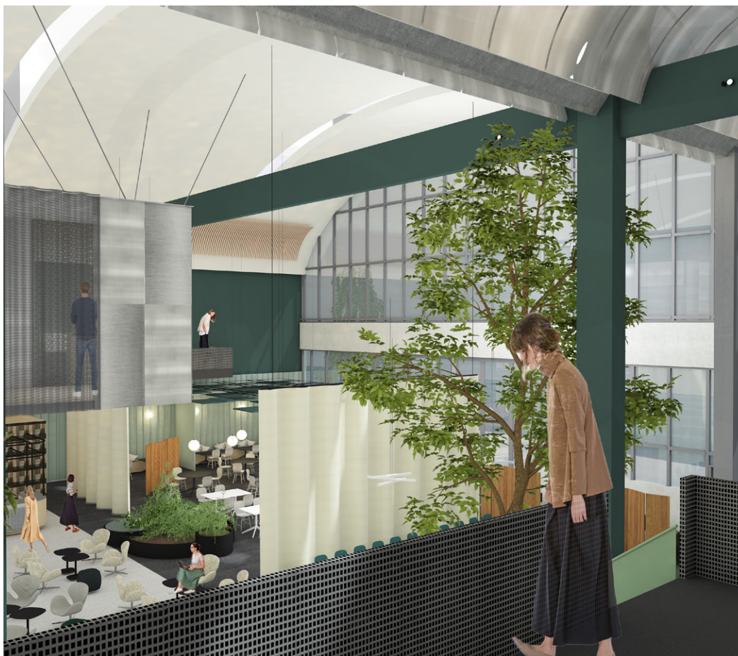
Område: Buehallene 2. etg Ombruk: Stålrister i rekkverk Metallplater i kube Trespiler i himling Lysarmatur gitter til himling Trepanel i vegg
