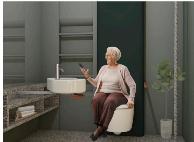
Flyttbar vask med hev/senk funksjon som tillater beboer å setle seg sittende.
