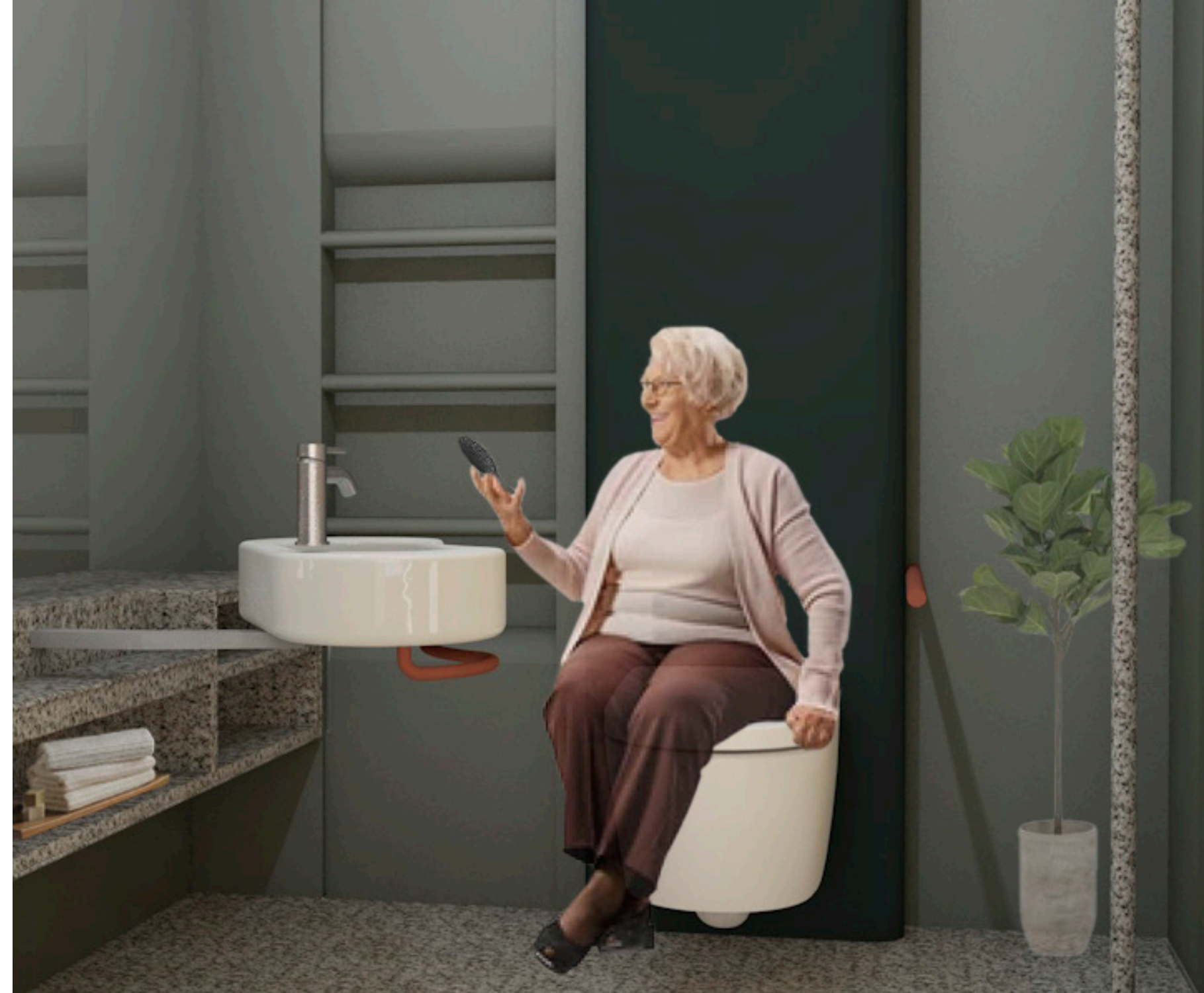
Flyttbar vask med hev/senk funksjon som tillater beboer å setle seg sittende.
