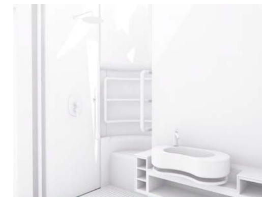
Skisse av baderom som illustrerer gripehåndtak som en del av arkitekturen og møbleringen.
