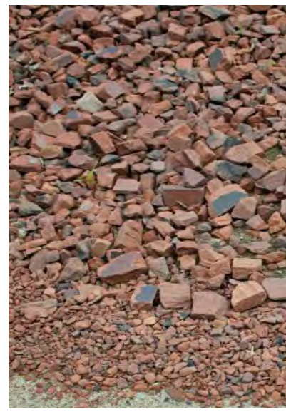
Tegl fra regjeringkvartalet knuses og legges som et underlag for det nye minne- og læringscenteret.
