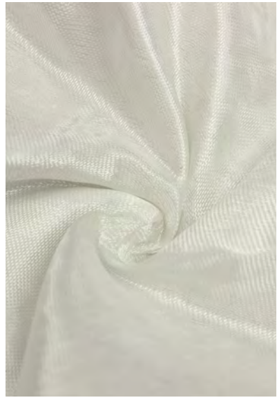
Glass fra regjeringskvartalet smeltes for å fremstille glassfiberduk.
